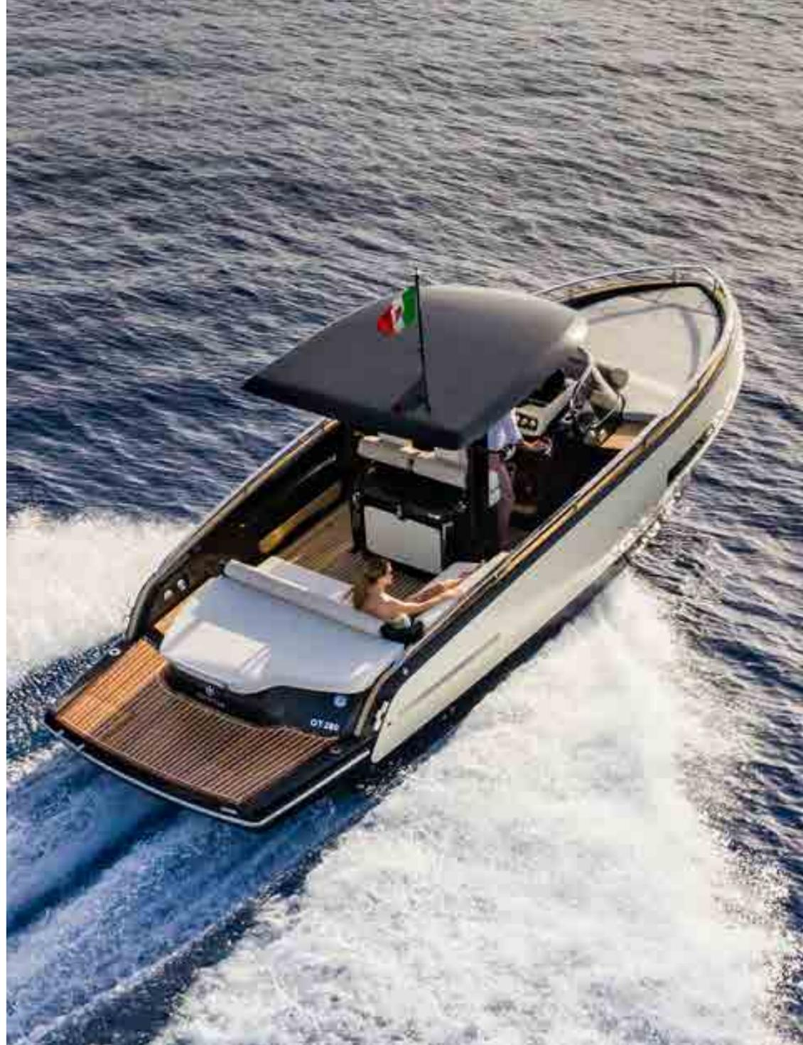
**Il modello GT 280, primo nato del cantiere, è caratterizzato da una prua semi-rovescia, tagliente e massiccia allo stesso tempo. La scelta di questa particolare conformazione prodiera introduce inoltre un aumento della lunghezza al galleggiamento, che si traduce in maggiore stabilità longitudinale.**
